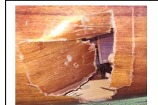
Ein riesiges Loch hinterließ die Flut im 8er-Canadier.
